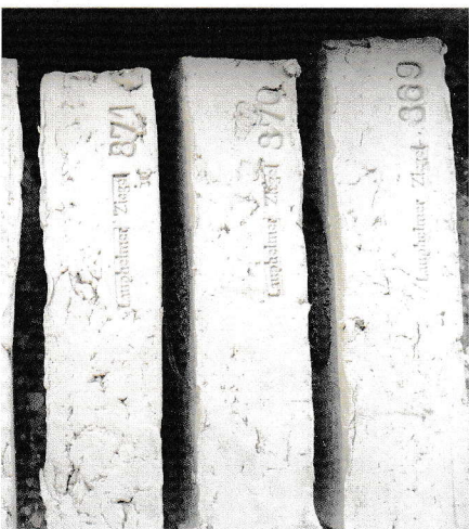
▲ Nummerierte Ziegel in der Trocknungsphase
